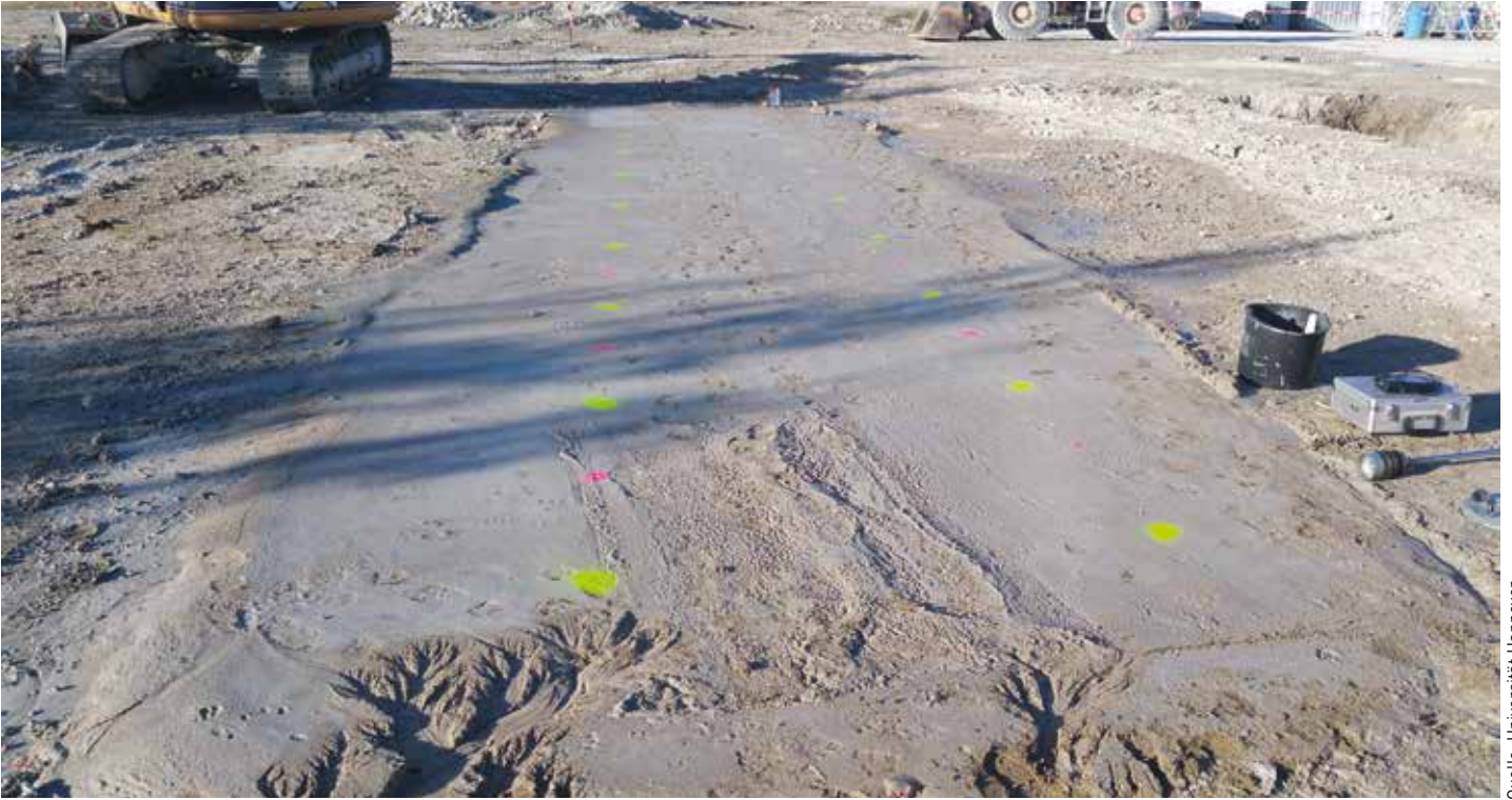
Mit Flüssigboden verfülltes Testfeld 1.
