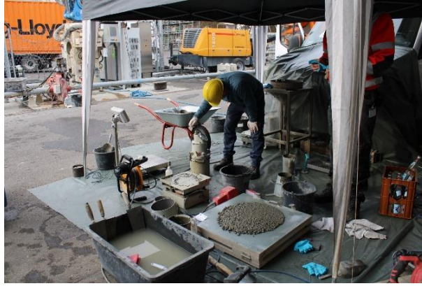
Abbildung 3-19: Durchführung von Begleituntersuchungen vor und nach dem Pumpen [Foto: Mikhalev].
