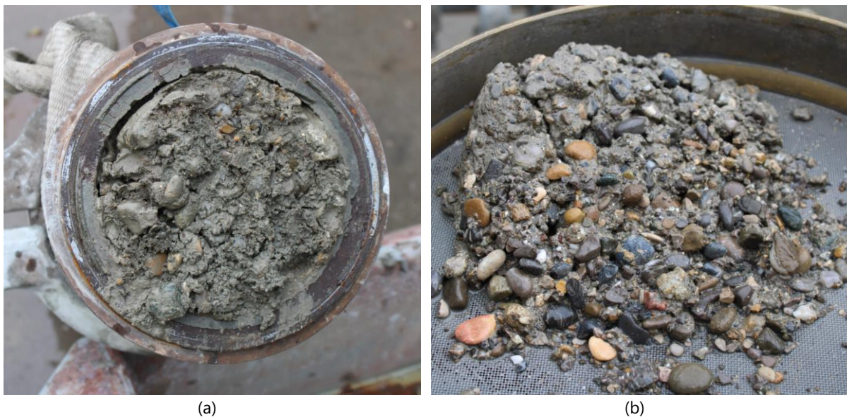
Abbildung 4-67: Foto einer blockierten Förderleitung (a) und einer entnommenen Betonprobe auf dem Sieb zur Auswaschung [Fotos: Mikhalev].
