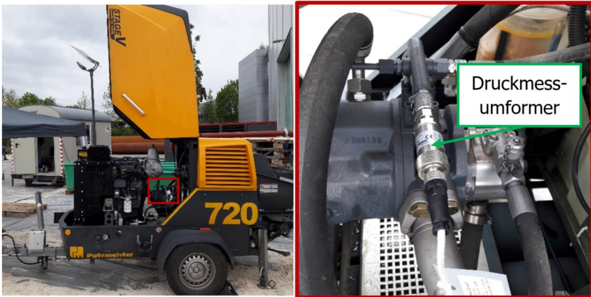
Abbildung 4-33: Foto der Betonpumpe (links) und Anschluss des Druckmessumformers im Motorraum der Betonpumpe (rechts) [Fotos: Mikhalev].
