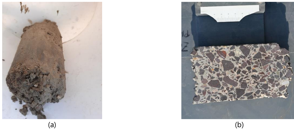
Abbildung 4-30: Fotos einer Blockierung im frischen (a) und im erhärteten Zustand (b) [Fotos: Mikhalev].
