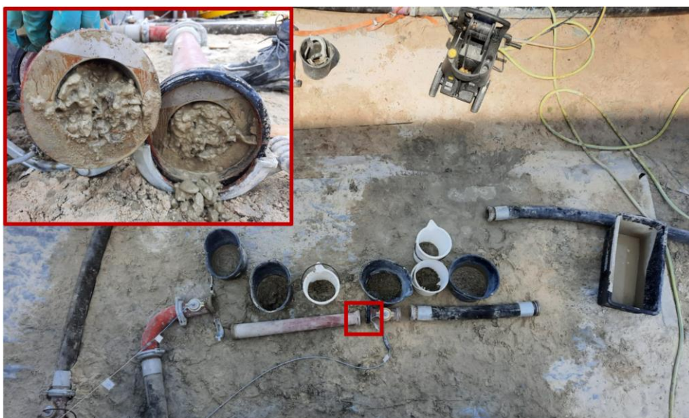
Abbildung 4-29: Übersichtsfoto der geöffneten Förderleitung mit blockiertem Beton A2-1 [Foto: Mikhalev / Cotardo].
