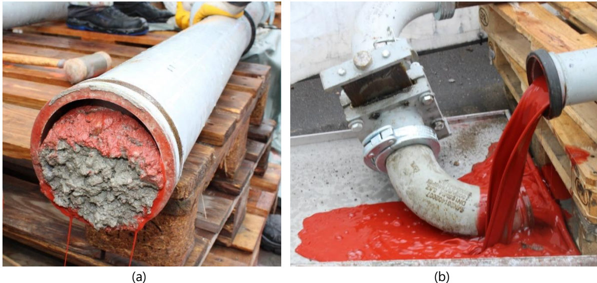
Abbildung 4-61: Industrieschlempe (a) benetzt den Außenbereich der Betonsäule ohne sich nennenswert mit dem Beton zu vermischen und (b) Großteil der Industrieschlempe wird vor der Betonfront geschoben [Fotos: Mikhalev].
