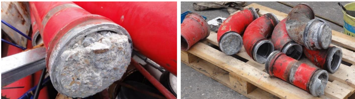
Abbildung 1-2: Beispiele blockierter Förderleitungselemente mit erhärtetem Beton [Secieru – 2018a].
