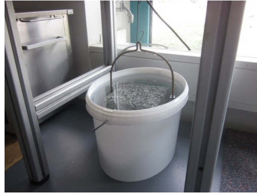
Abb. 3: Tauchwägung für den Hohlraumgehalt
