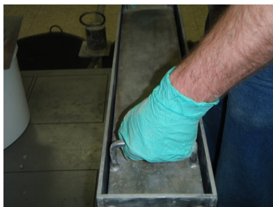
Abb. 28: Befüllung und Verdichtung der Probekörper
