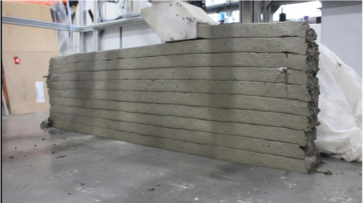
Abbildung 25: Wand mit den Maßen  $u/v/w$  140/15/50 cm<sup>3</sup> zur Probekörpergewinnung.
