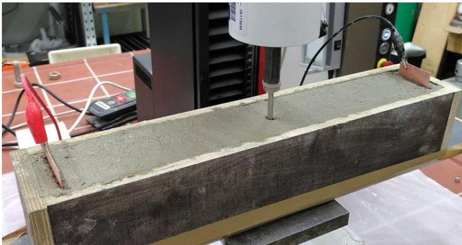
*Abbildung 14: Experimentieranordnung zur gemeinsamen Erfassung der Penetrationskraft in einem quasistatischen Versuch sowie des elektrischen Widerstandes an einem 3D-Druckbeton.*
