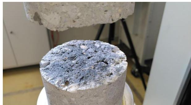
Abbildung 34: Bruchfläche einer Zugprobe vom Typ BK-100 w.
