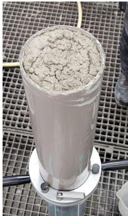
Abbildung 6: Oberflächenmorphologie des zementreduzierten Betons nach Abschluss der Messungen im Gleitrohrrheometer (1+9 Hübe).
