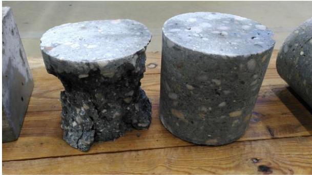
Abbildung 29: Zylinderproben für den Druckversuch nach (links) und vor (rechts) der Belastung.
