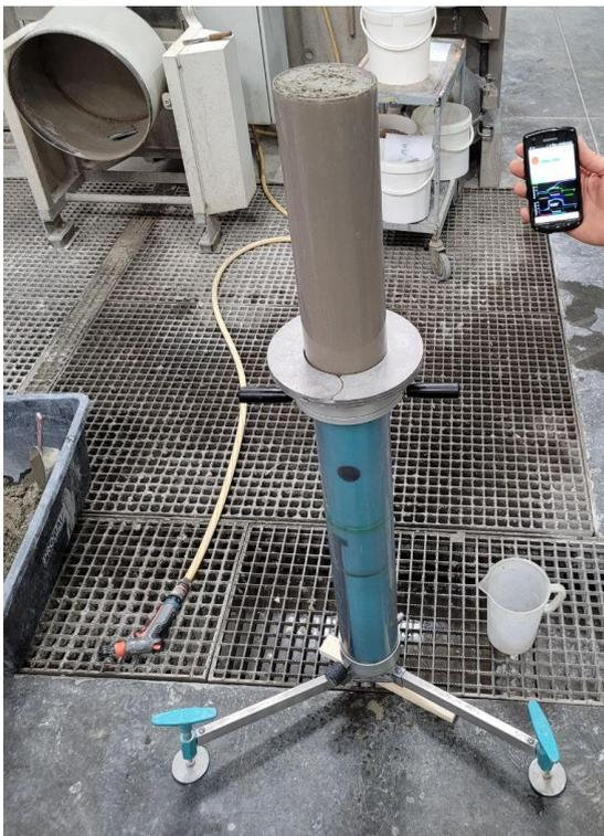
Abbildung 5: Gleitrohrrheometer (Fa. Schleibinger) befüllt mit Basisbeton, Ballaststufe 1.
