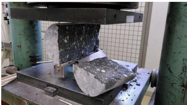
Abbildung 33: Zylinderprobe vom Typ: BK-150 v.u/w nach dem Spaltzugversuch.
