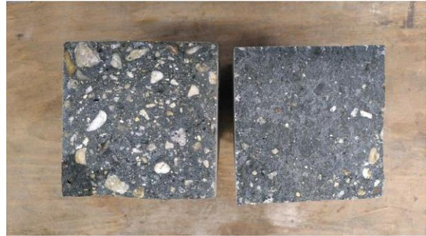
Abbildung 30: Bruchfläche von Prismen aus dem Biegezugversuch. Links: Probe aus konventioneller Herstellung in Schalung (P-400 cast). Rechts: 3D-gedruckte Probe mit Orientierung u.w (P-400 u.w).
