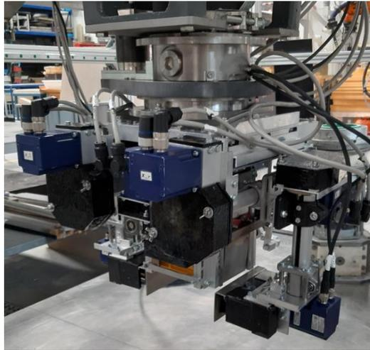
*Abbildung 45: Gleitende Schalung als Formgebungsmodul [52]; [54]*
