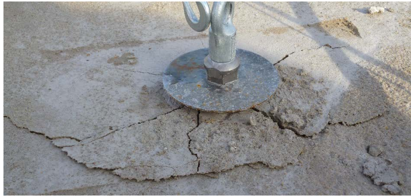
Abbildung 5-14: Exemplarische Ausbildung eines Bruchkörpers zum Versuchszeitpunkt 7 d mit einer Pfahlänge von 33 cm
