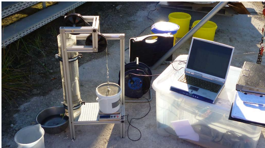
Abbildung 4-6. Exemplarische Durchführung des Versuches mit Modifizierter ViskoWaage
