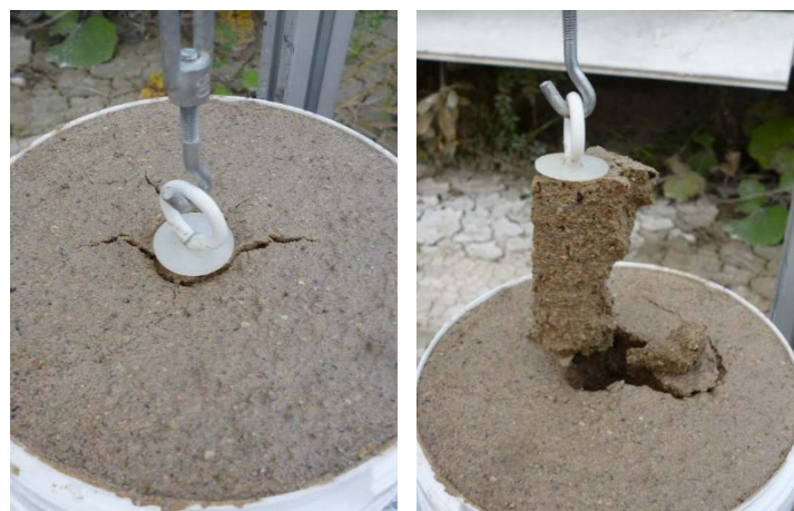
Abbildung 5-8: Exemplarische Verankerungskörper nach Herausziehen aus dem Flüssigboden 3 – 4 h nach Grabenverfüllung
