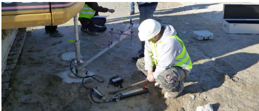
Abbildung 4-5: Exemplarische Durchführung eines statischen Lastplattendruckversuches durch das IGtH
