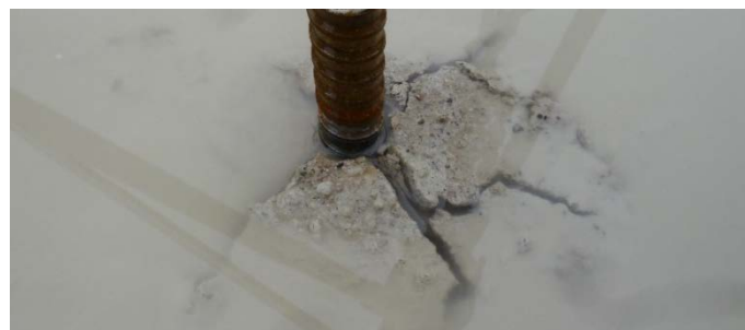
Abbildung 5-17: Exemplarische Ausbildung eines Bruchkörpers zum Versuchszeitpunkt 7 d
