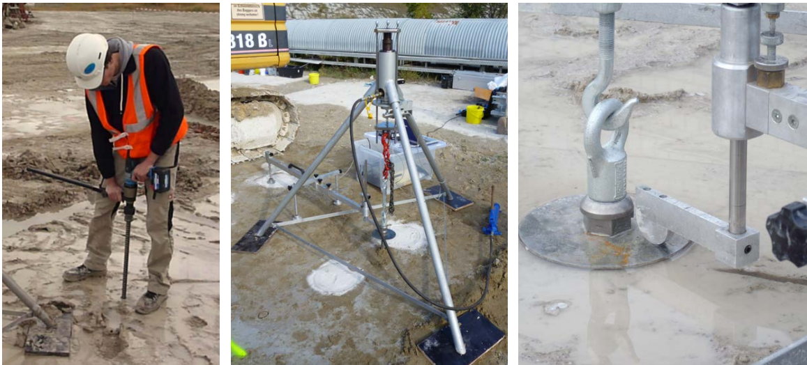
Abbildung 4-3: Exemplarische Darstellung eines Pfahlzugversuches
