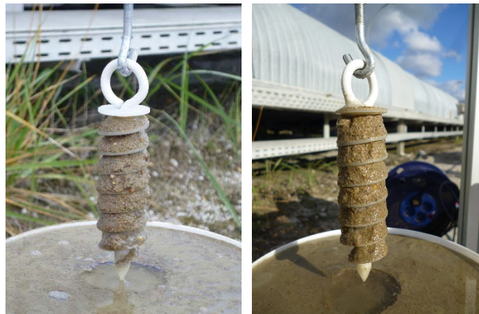
Abbildung 5-5: Exemplarische Verankerungskörper nach Herausziehen aus dem Flüssigboden 1 – links 0 h und rechts 2 h nach Grabenverfüllung
