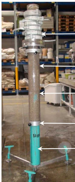
Bild 12. a) Gleitrohr-Rheometer (Sliper) mit Gewichten b) eine mittels Sliper ermittelte Pumpendruck-Fördermenge-Beziehung.
