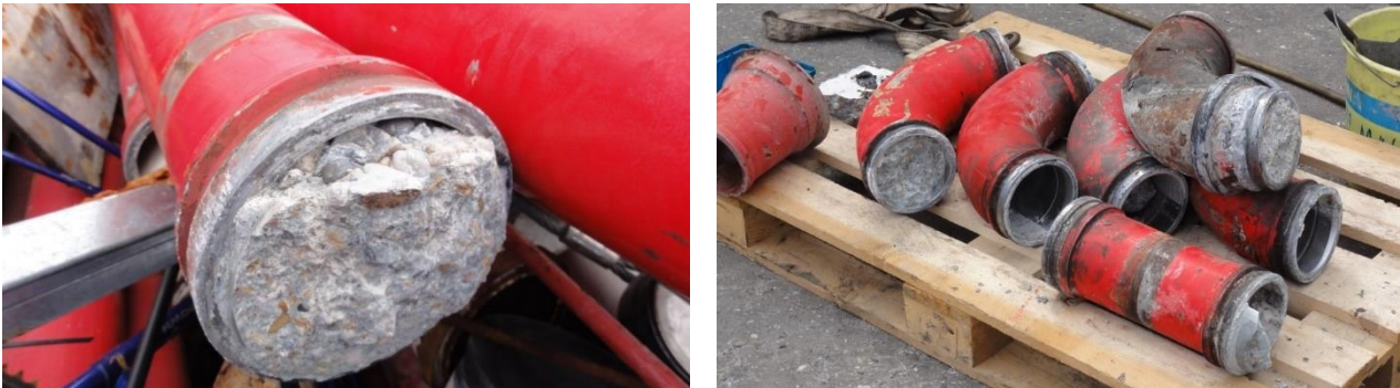
Bild 1. Betonpumprohre mit erhärtetem Beton als Folge von Verstopfern [21].
