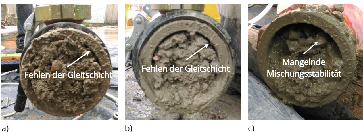
Bild 32. Mögliche Ursachen für Rohrverstopfungen: a) mangelhafte Zusammensetzung der Vorlaufmischung; b) fehlerhafte Zusammensetzung der Betonmischung; c) unzureichende Mischungsstabilität des Betons [30].
