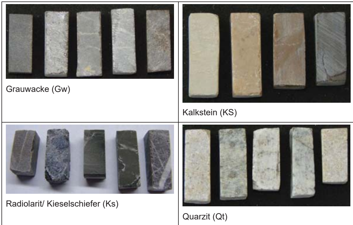
Abb. A- 36: Aufnahmen der Prismen (Querschnitt 7 x 7 mm 2 ) für die Bestimmung des linearen Wärmeausdehnungskoeffizienten \alpha_T für den Kies K7
