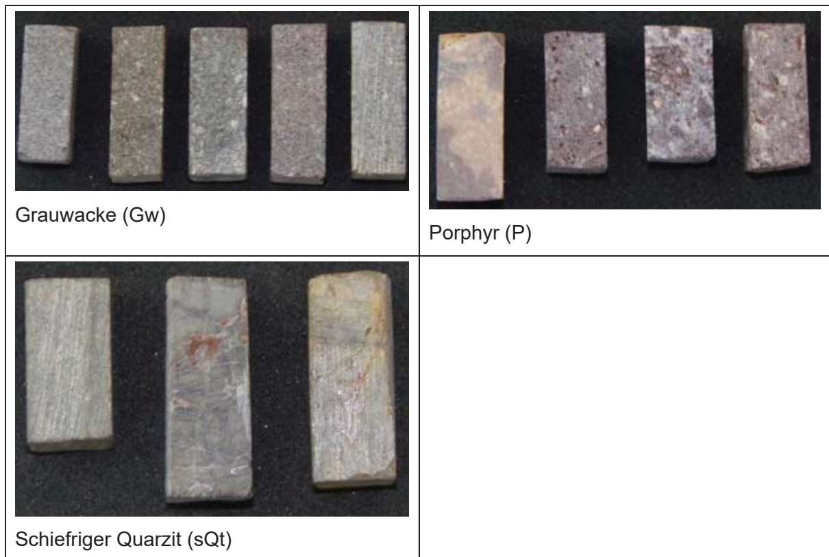
Abb. A- 42: Aufnahmen der Prismen (Querschnitt 7 \times 7 \text{ mm}^2 ) für die Bestimmung des linearen Wärmeausdehnungskoeffizienten \alpha_T für den Kies K9
