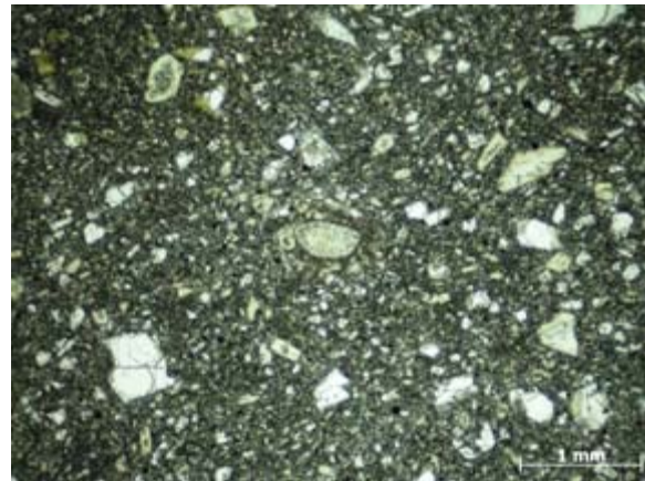
Abb. 34: N11, porphyrisches Basaltgefüge; einfach Pol.
