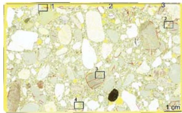
Abb. 113: K5-III-4 mit Markierung der Risse (rot), Messpunkte der Abwitterungstiefen (blau) und Lage der Fotoaufnahmen nach CDF auf einer Dünnschlifffläche von 6*10 cm 2
