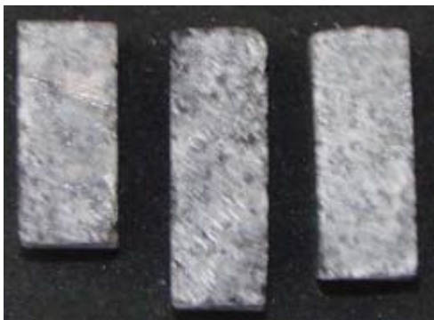
Abb. A- 13: Aufnahmen der Prismen (Querschnitt 7 x 7 mm 2 ) für die Bestimmung des linearen Wärmeausdehnungskoeffizienten \alpha_T für den Gabbro N16
