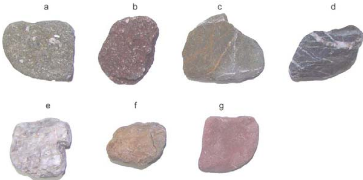
Abb. 11: Zusammensetzung Zorgekies (a: konglomeratische Grauwacke, b: Porphyry, c: schieferiger Quarzit, d: Kieselschiefer, e: Quarzit, f: Tonschiefer, g: Sandstein)
