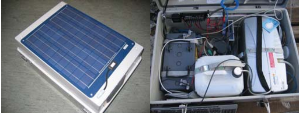
Bild 3: Kunststoffbox mit fest angebrachtem Solarmodul (links) und Brennstoffzelle, Treibstofftank sowie Solarakku (rechts)
