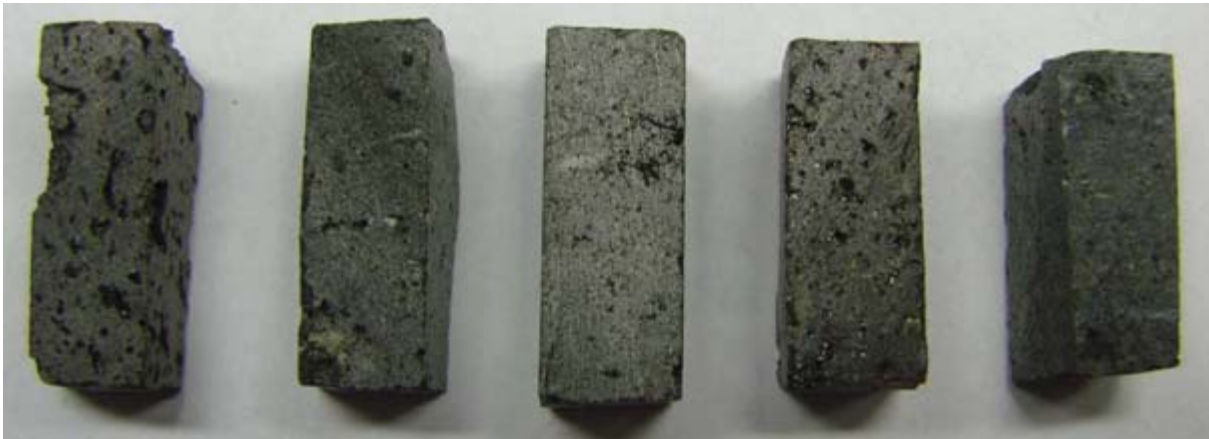
Abb. A- 19: Aufnahmen der Prismen (Querschnitt 7 x 7 mm 2 ) für die Bestimmung des linearen Wärmeausdehnungskoeffizienten \alpha_T für den Basalt N18
