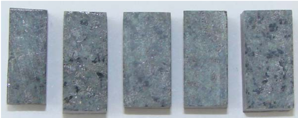
Abb. A- 7: Aufnahmen der Prismen (Querschnitt 7 x 7 mm 2 ) für die Bestimmung des linearen Wärmeausdehnungskoeffizienten \alpha_T für den Diabas N14
