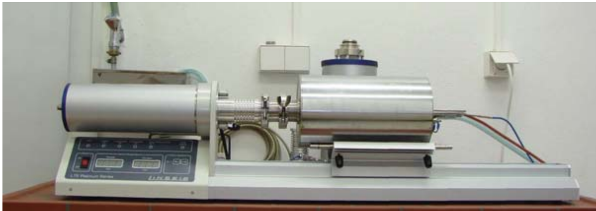
Abb. 2: Dilatometer DIL L75/76 Platinum Serie, Firma Linseis Messgeräte GmbH
