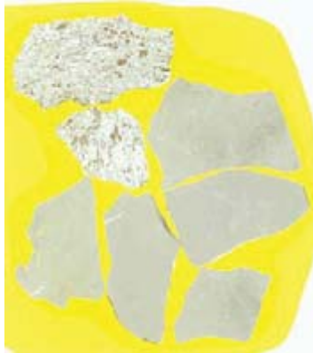
Abb. 114: Dünnschliff N22-FTSW mit Einzelkörnern nach der Dosenfrostprüfung
