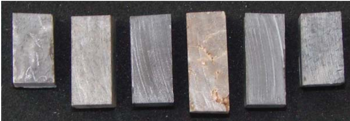
Abb. A- 4: Aufnahmen der Prismen (Querschnitt 7 x 7 mm 2 ) für die Bestimmung des linearen Wärmeausdehnungskoeffizienten \alpha_T für den Muschelkalk 1 N13
