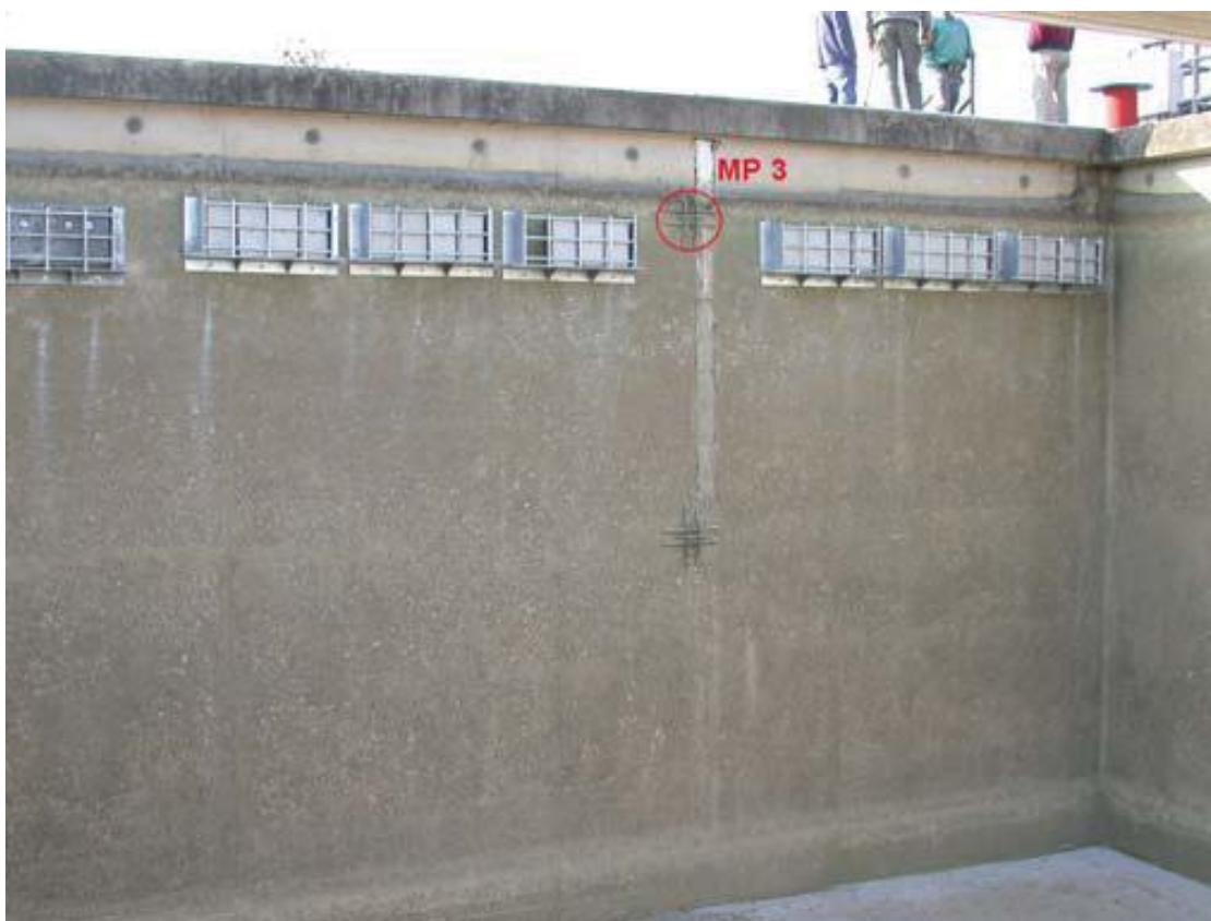
Bild 1: In der Wasserwechselzone eines Sparbeckens der Schleuse Hilpoltstein angebrachte Probekörper und Position des Messpunktes „MP3“
