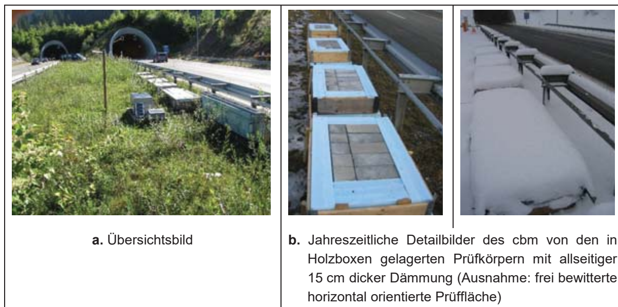
Bild 3: Impressionen von der Auslagerung der Prüfkörper auf dem Mittelstreifen der B2 in der Nähe des Tunnels Farchant
