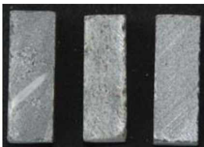
Abb. 14: Aufnahmen der Prismen (Querschnitt 7 x 7 mm 2 ) für die Bestimmung des linearen Wärmeausdehnungskoeffizienten \alpha_T für den Muschelkalk N22
