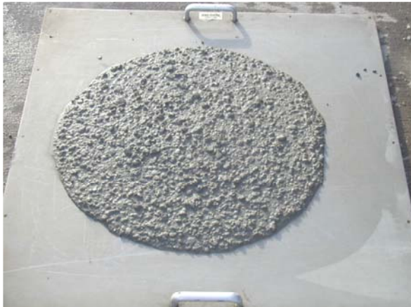
Bild C42: Betonage Probewand 3 ( t = 60 \text{ min} , sm = 65 \text{ cm} , T = 9,8 \text{ s} )
