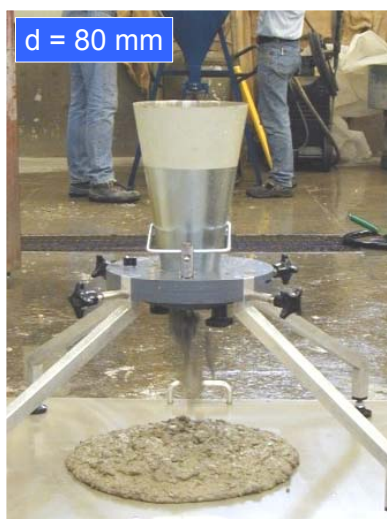
Bild C65: Auslaufkegel – Ausfließverhalten bei unterschiedlichen Ausläufen
