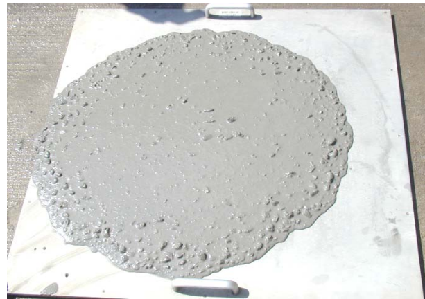
Bild C25: Betonage Wand 2 ( t = 20 min, sm = 75 cm, T = 8 s)
