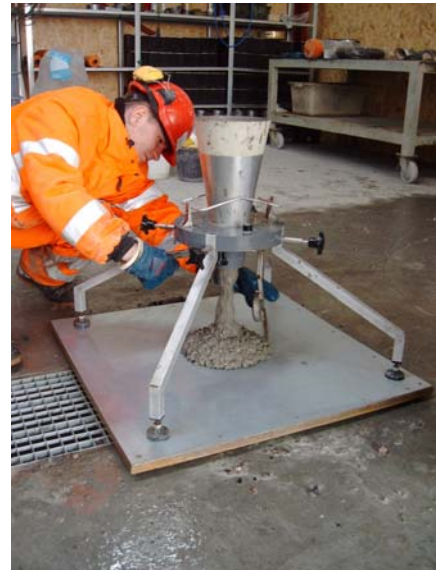
Bild C67: Auslaufkegel - Praxiseinsatz in Malmö
