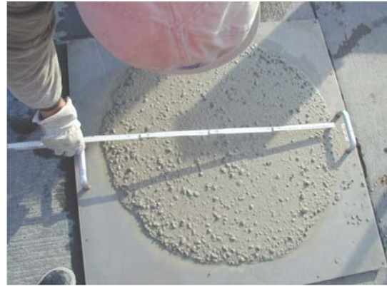
Bild C41: Betonage Probewand 3 ( t = 5 \text{ min} , sm = 75 \text{ cm} , T = 5,4 \text{ s} )
