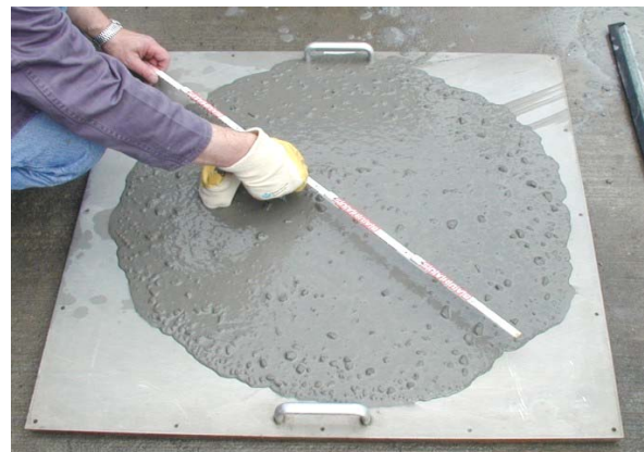
Bild C13: Betonage Abschnitt 1 (t = 85 min, sm = 79 cm, T = 6 s)
