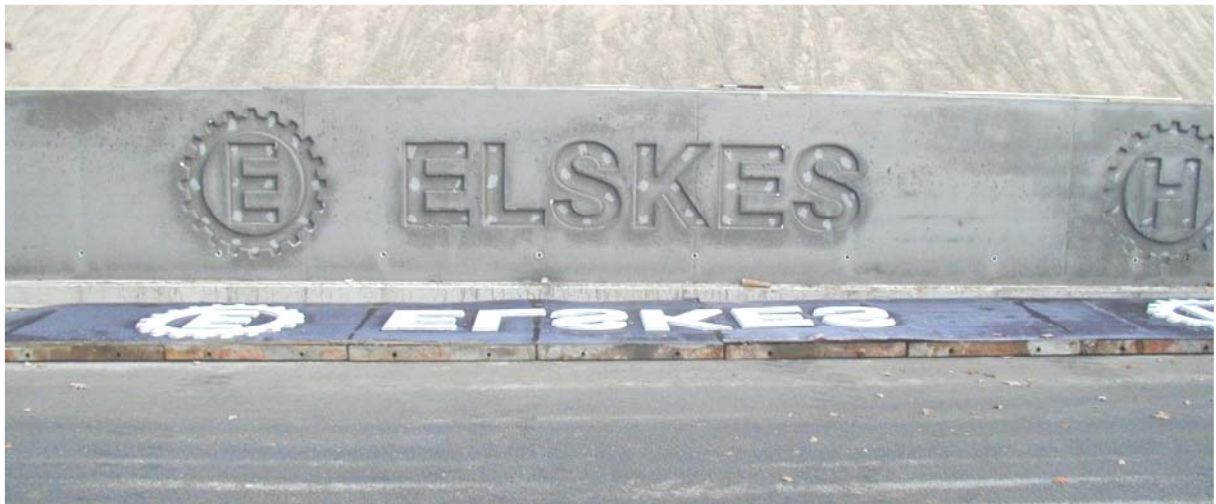
Bild C52: Probewand 3 – Ausschalen - Oberflächeneigenschaften - Gesamtübersicht
