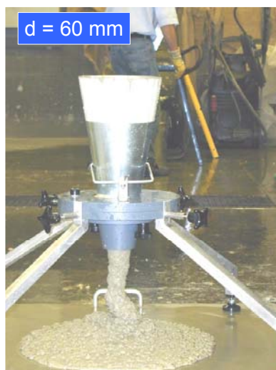
Bild C65: Auslaufkegel – Ausfließverhalten bei unterschiedlichen Ausläufen
