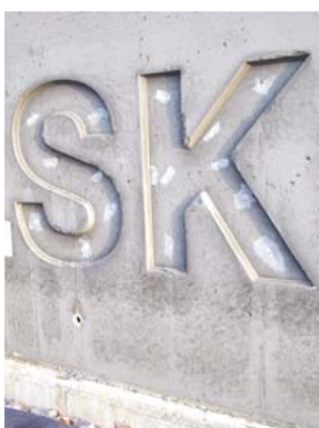
Bild C50: Probewand 3 - Ausschalen - Oberflächeneigenschaften
