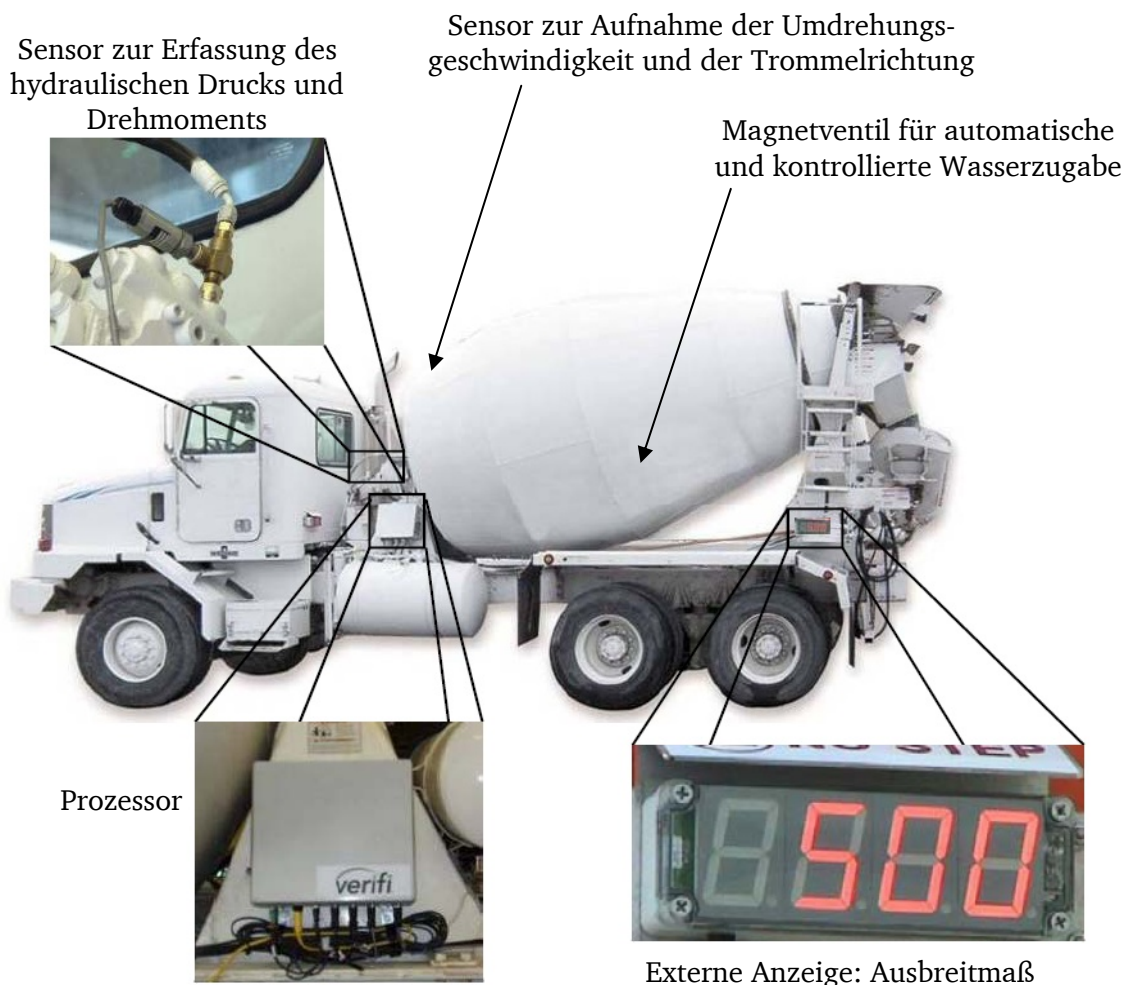
Abbildung 1: Bestandteile des Systems Verifi auf einem Fahrmischer (Quelle: Koehler, E., Grace)
