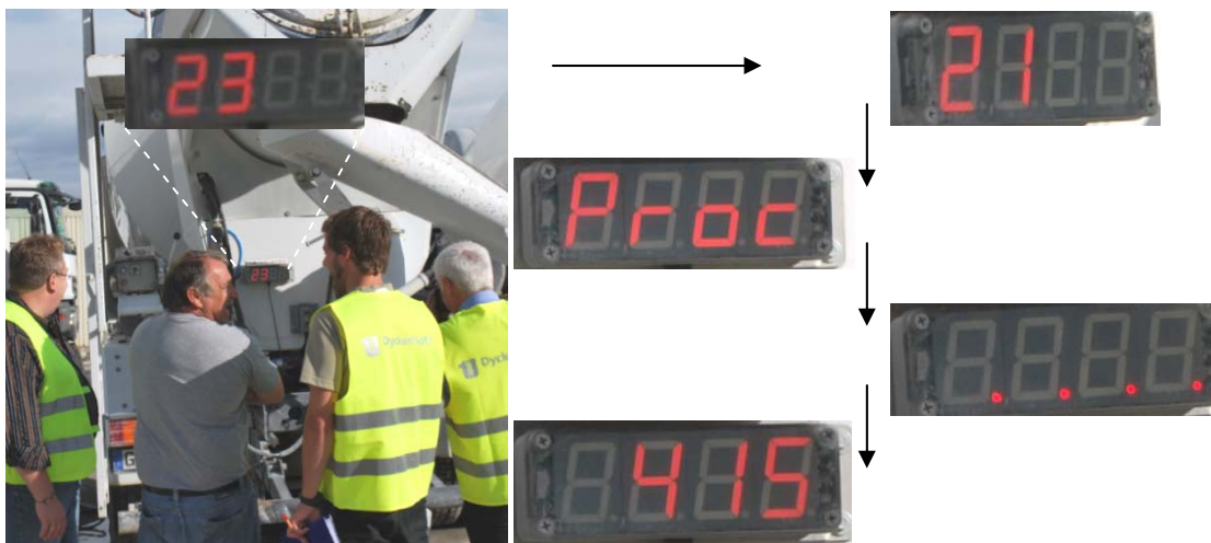
Abbildung 2: Anzeigenfolge des Systems Verifi (beispielhaft), Mix Countdown - Processing - Abwarten des Wertes - Anzeige des ermittelten Ausbreitmaßes
