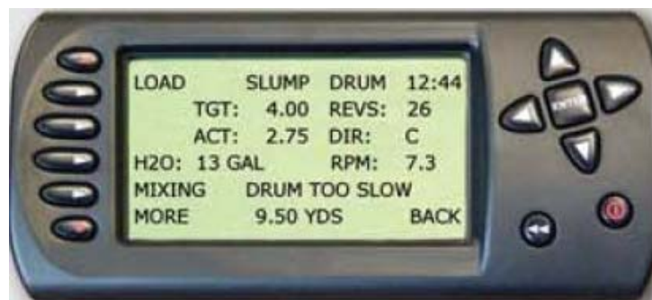
Abbildung 3: Bedienfeld des Systems Verifi im Fahrerhaus für die Kontrolle und Einstellung durch den Fahrer, hier wird das Setzmaß (Slump) angezeigt (Quelle: RS Solutions)
